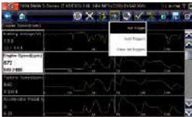
Affichage maximum de 4 graphiques de données réelles en même temps. Récupération des anomalies difficiles à trouver grâce aux fonctions de déclenchement, d'enregistrement, de lecture et de zoom de mise à l'échelle.
